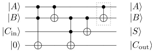
Temos nesse circuito duas variações de uma porta lógica que chamaremos de  $\text{CNOT}(q_c, q_t)$  e  $\text{CCNOT}(q_{c_1}, q_{c_2}, q_t)$ . No desenho, o qubit  $q_t$  aparece marcado com um  $\oplus$ . A porta lógica  $\text{CNOT}(q_c, q_t)$  pode ser vista como sendo igual a  $\text{CCNOT}(q_c, q_c, q_t)$ , ou seja, a aplicação da porta lógica  $\text{CCNOT}$  com  $q_c = q_{c_1} = q_{c_2}$ .
